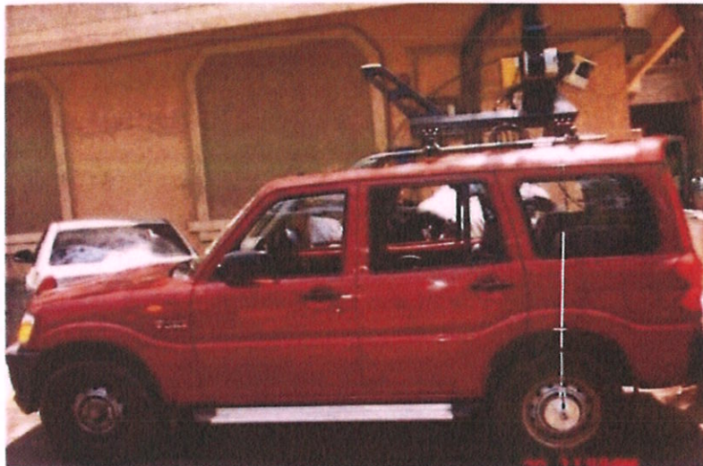
Mobile LiDAR Van
